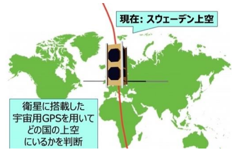
図 2 衛星搭載宇宙用 GPS の利用
