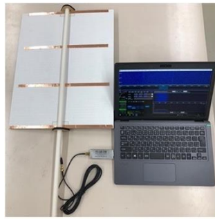
図 7 段ボール八木アンテナを使った衛星受信システム
