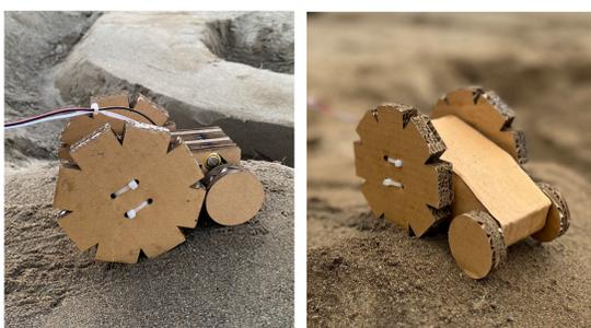
ロボットの数台試作品を製作して、実際にレゴリス（砂）上を走って、実現可能かを検証した。
