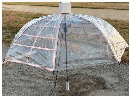
図 11 傘型アンテナの設置実験の様子
