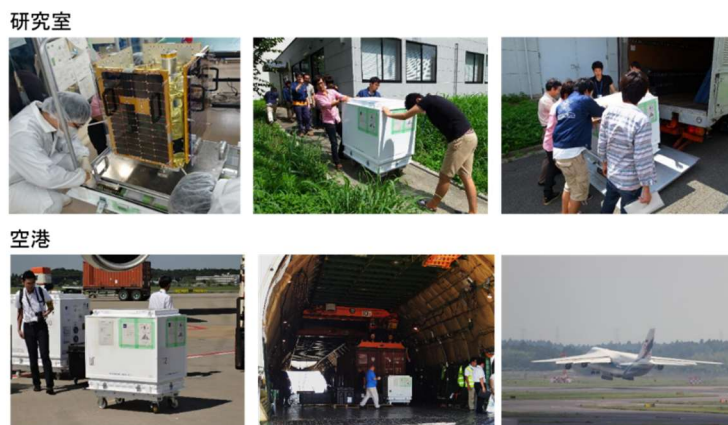
図10 輸送作業：衛星を専用コンテナに入れ、エアサス車両で運送し、アントノフで空輸
