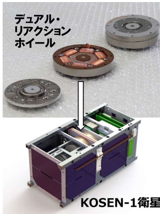
写真5 KOSEN-1衛星の中央部に搭載された新しい方式の姿勢制御装置「デュアル・リアクションホイール」
