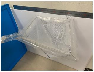
図 2.6: 展開用チューブに空気を注入した実験機の様子
