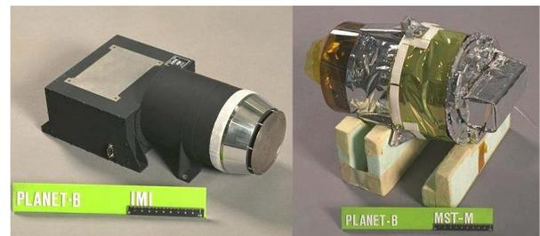
図 5: (左)イオン質量分析器 (IMI)、(右)磁場計測器 (MGF)
