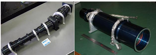
図 4: (左)CIB/黄道光観測分光装置、(右)CIB/黄道光観測撮像装置
