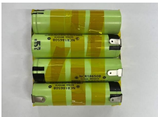
図 4.2.4 4 直列に接続された NCR18650B
