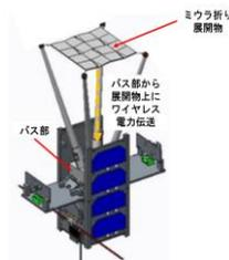
図 1.2 太陽光パネルからバス部での電力伝送例
