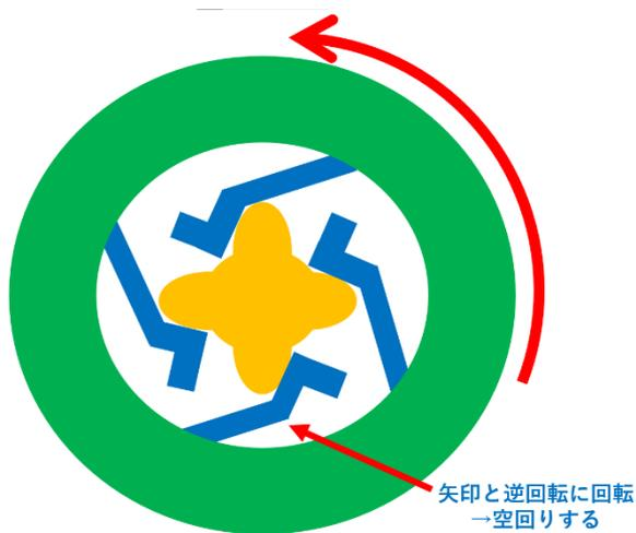
図 2.14 VDM ワイヤ巻取り機構空回り機構概念図
