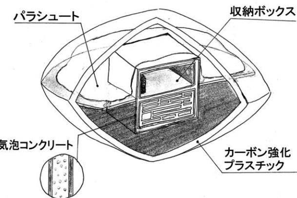
図1：タイムカプセルの構造
