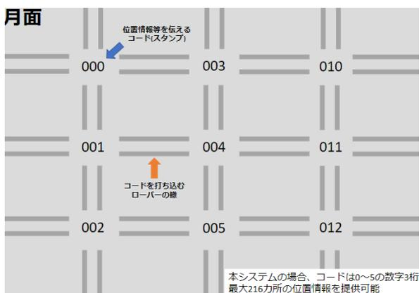
図1 本システムの概要図
