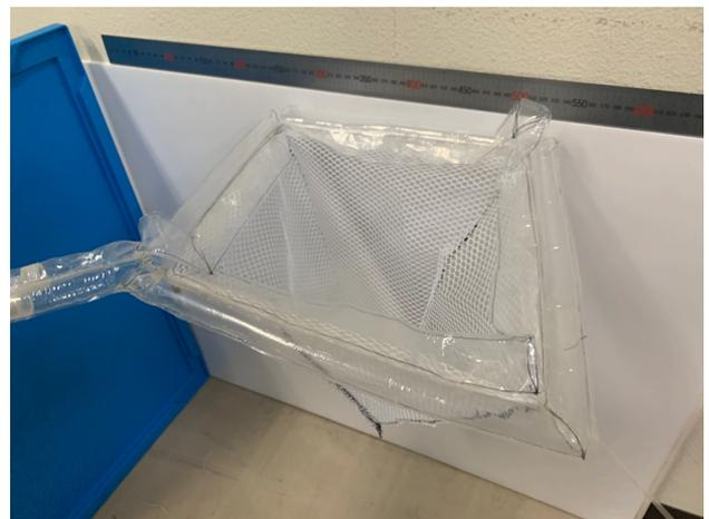
図 2.6: 展開用チューブに空気を注入した実験機の様子
